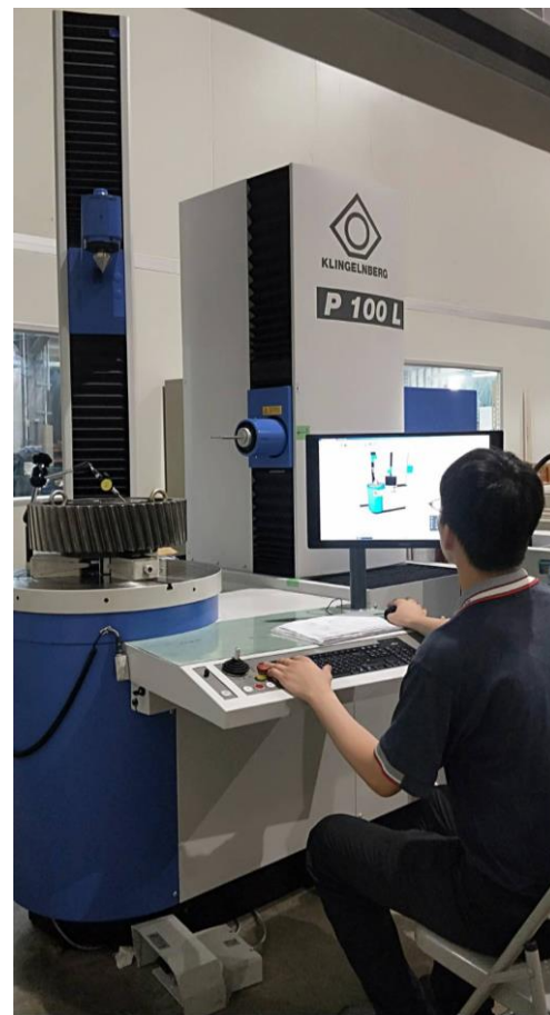
德國Klingelberg 齒形檢驗機( \varnothing 1200\text{mm} )
